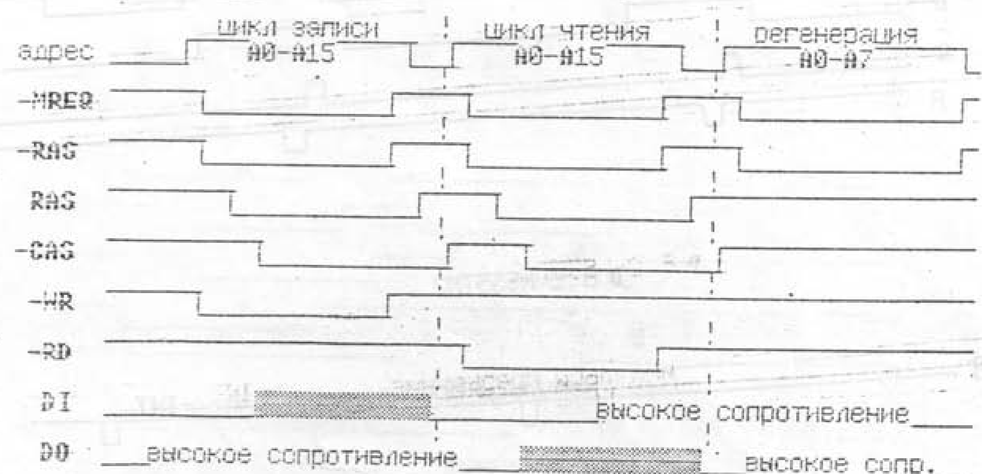
временные диаграммы формирования сигналов -RAS, -CAS при обращении ЦП к ОЗУ динамического типа
